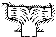
Рис. 14. «Утяжина» при выдавливании
