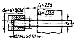
Рис. 34. Ограничение выступающей длины прутка за пределы конического пуансона при D_K \leq 1,25d
